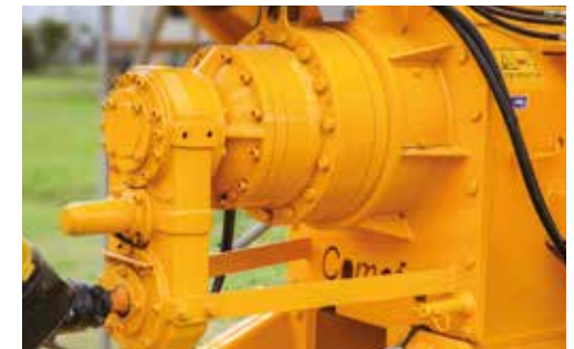
ÁRBOL ENTRADA DE POTENCIA
